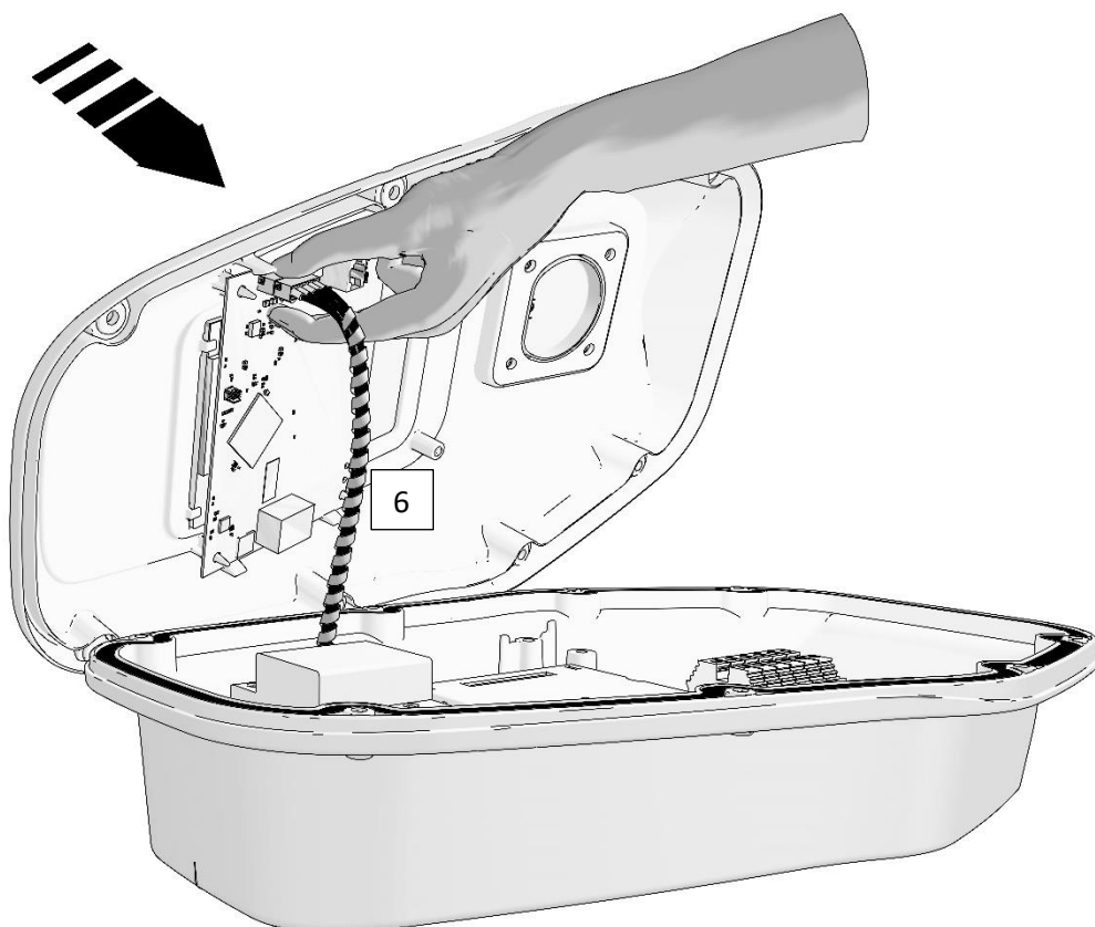
Ilustracja 6 Odłączanie kabla połączeniowego
